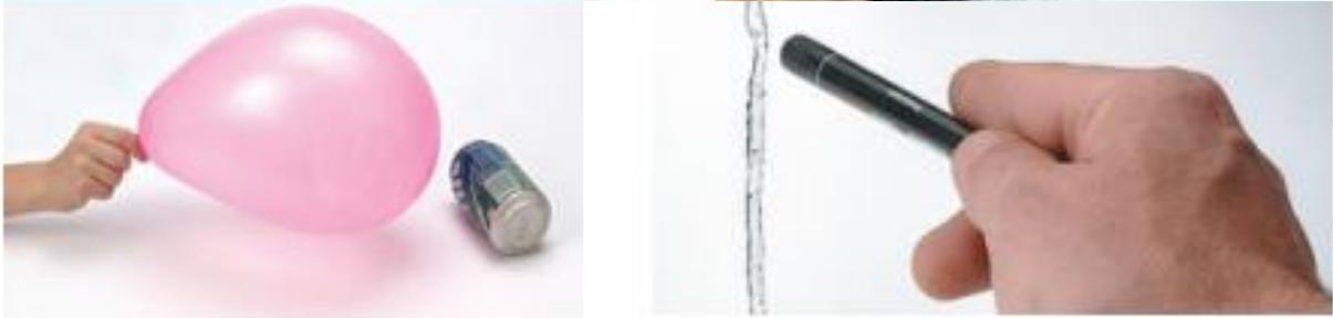
El globo, después de ser frotado varias veces con un jersey de lana atrae una lata metálica.
